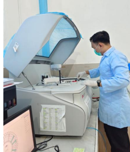
Memasukan cup sampel berisi serum kedalam alat Biosystem BA 200 untuk melakukan pemeriksaan kreatinin
